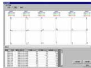
支保工立込精度、変形量
